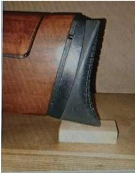
**Il controllo che il vivo di volata punti sopra il cartello porta bersaglio sarà effettuato posizionando, nel punto piu' basso del calciolo, una DIMA dello spessore di 30 mm**
