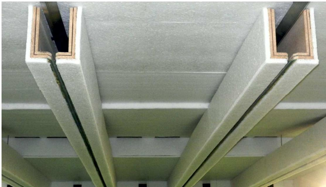
Figura 33 – Binari di scorrimento con protezione dei meccanismi di sostegno e movimento dei bersagli
