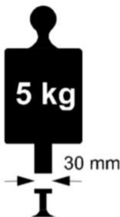
Lo strumento utilizzato per misurare lo spessore degli indumenti e delle scarpe deve essere in grado di misurare fino a un decimo di millimetro (0,1 mm). Le misurazioni devono essere effettuate applicando un peso di 5.0 kg. Lo strumento deve avere due (2) superfici piatte circolari una di fronte all'altra, con un diametro di 30 mm ciascuna.
